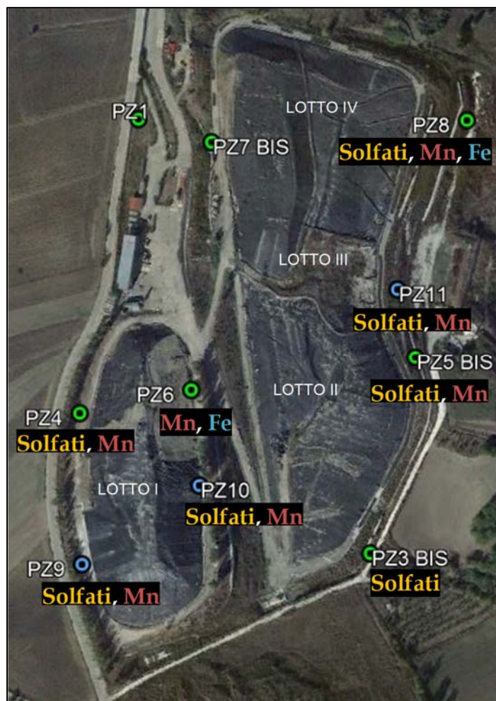
Fig.11: Schema superamenti frequenti ai vari piezometri
