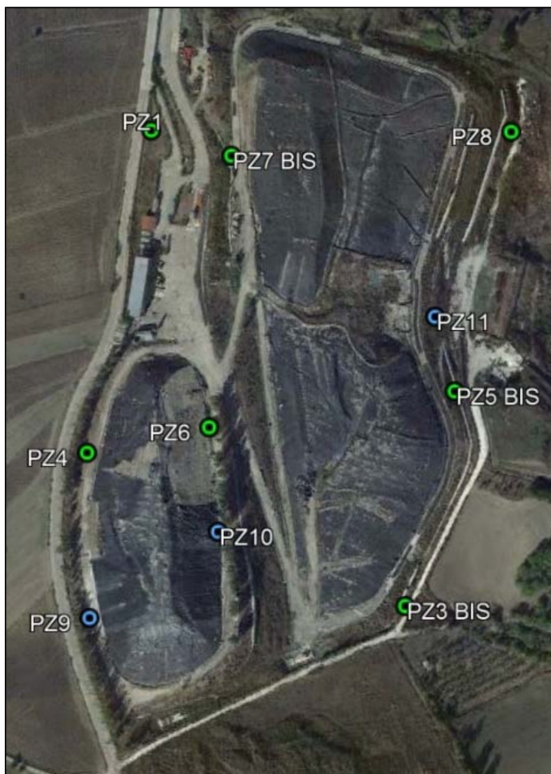
Fig.10: Localizzazione piezometri: in blu i piezometri di nuova progettazione (realizzati a fine 2017)
