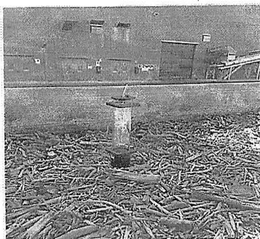
Figura 2. Campionatore passivo e contenitore in nalophan
